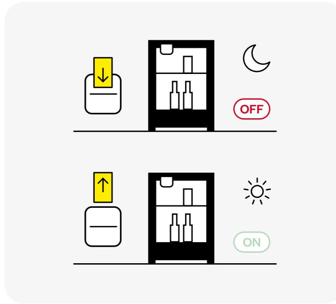
ECO MODE - Nel caso in cui la camera non sia impegnata da un ospite per più di 24 ore, il minibar attiva la funzione Eco Mode con un ulteriore risparmio energetico fino al 30%.
